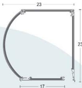
*El cajón WINBLOCK fabricado en aluminio extrusionado, puede servirse en una amplia gama de colores.*
